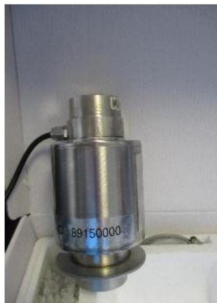
Per verificare che le celle siano state configurate correttamente entrare nel passo **Calibrazione >> Selezione bilancia >> configurazione numero di serie >> configurazione cella digitale**. Comparirà quindi un messaggio di corretta o errata configurazione delle celle.
